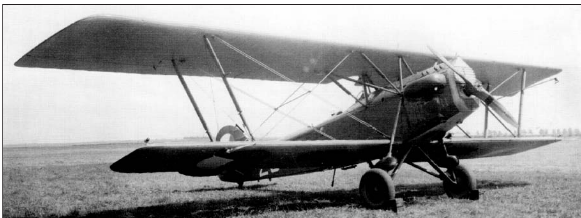
Horní foto – Vojenský letoun A 230.1 navazoval na model A 30. Motor Škoda Lorraine Dietrich 12 Cc – 450 k (330 kW). Vybava – kulomet a podvěšené bomby. Dolní foto – Vojenský letoun A 230.20 – sériová varianta A 230 s obdobnou výbavou.
