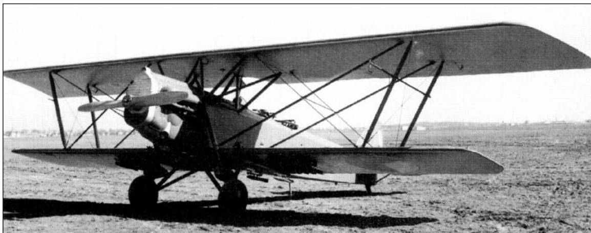
Horní foto – Vojenský letoun A 230.1 navazoval na model A 30. Motor Škoda Lorraine Dietrich 12 Cc – 450 k (330 kW). Vybava – kulomet a podvěšené bomby. Dolní foto – Vojenský letoun A 230.20 – sériová varianta A 230 s obdobnou výbavou.
